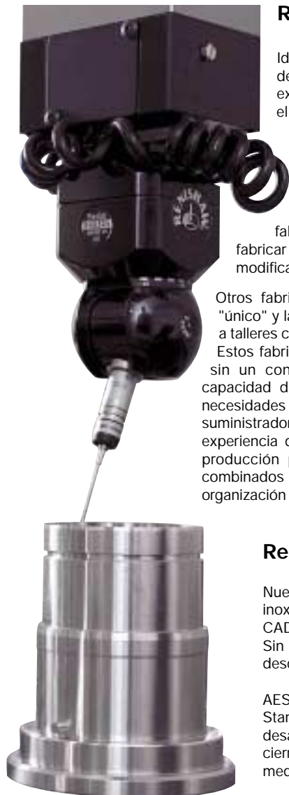
Inspección controlada por ordenador (CNC) de un componente.
