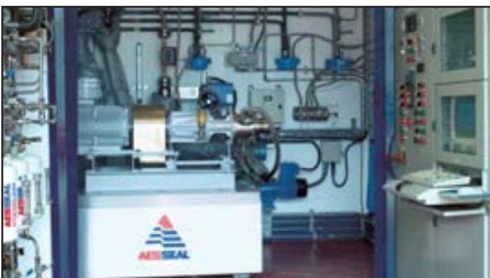
Célula API 682 de Aceite Caliente (240°C/464°F) - Uno de los CINCO bancos de prueba dotados de las últimas tecnologías que se encuentran en el cuartel general de AESSEAL®.
